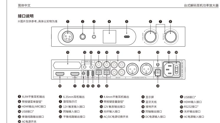
\*注:前后面板2个USB口都插入设备时,前面的USB口优先,后面的USB口无效。 \*带按键菜单旋钮:旋转切换工作模式/切换菜单;短按确认,长按返回上一级。
